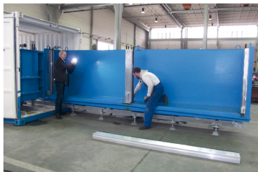
Bild 7: Vorbereitung der großen Prüfbox für die Prüfung eines L-Systems Die vorbereiteten Wandanschlüsse und die Mittelstütze sind erkennbar. Foto: Sängner
