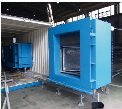
Bild 6: Prüfcontainer mit ausgeführter kleiner Prüfbox zur Prüfung eines O-Systems Foto: EVH
